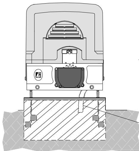
Nella fase preliminare di posa, i piedini dovranno sporgere di 5-10 mm. per permettere allineamenti, fissaggio della cremagliera e regolazioni successive. L'accoppiamento esatto con la linea di scorrimento del cancello è ottenibile dal sistema di regolazione integrale (brevettato) composto da:
